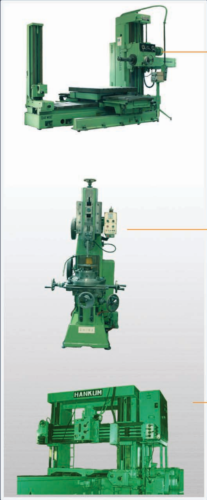
기계명 Slot Machine 기계사양 - 좌우이동거리 110mm - 상하이동거리 200mm - Table Size 500mm - 행정거리 250mm Equipment Name Slot Machine Machine Shape - Renovel Distance Left and Right 110mm - Top and Bottom Renovel Distance 200mm - Table Size 500mm - Operative Distance 250mm
