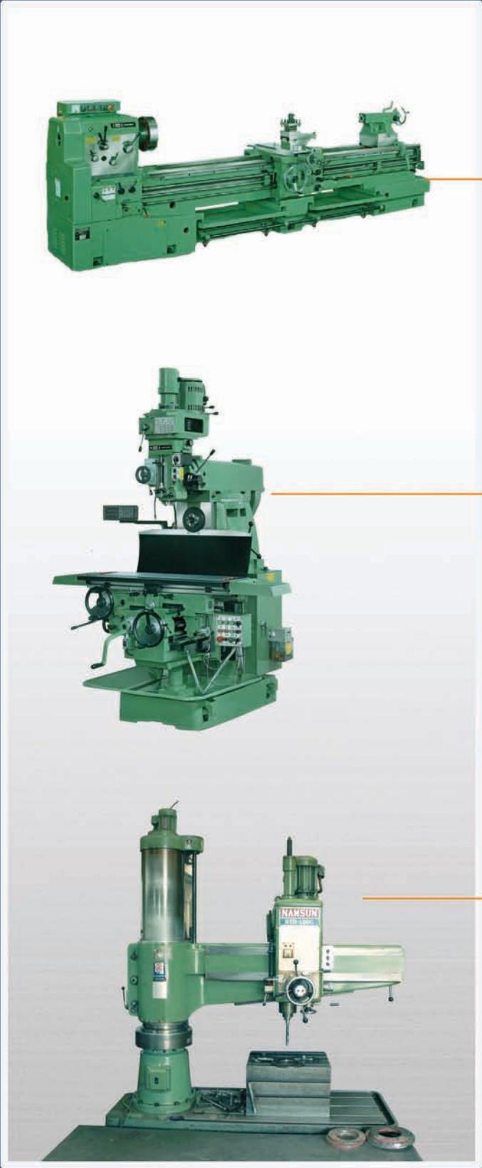
기계명 Oil Country Lathe 기계사양 - 베드상의 스윙 710mm - 양센타간의 거리 4000mm - 갭상의 스윙 12000mm Equipment Name Oil Country Lathe Machine Shape - Swing in Bed 710mm - Distance Core to Core 4000mm - Swing in Gap 1200mm
